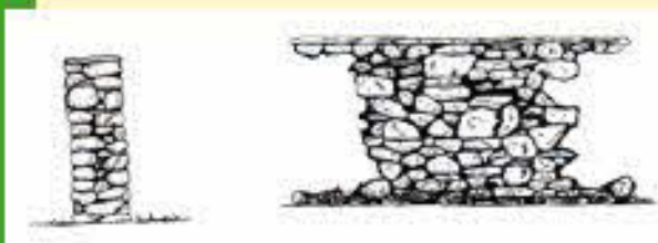
Esempio di muro di confine o di contenimento
