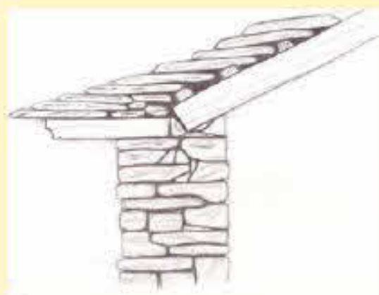
Esempio di copertura con sotto-gronda in legno
