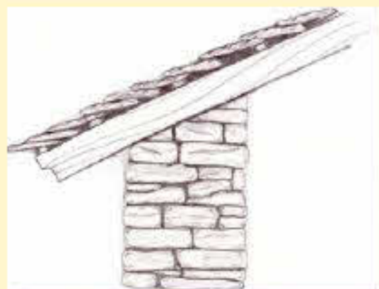
Esempio di copertura semplice
