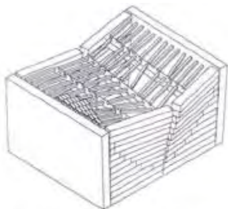
Fig. 4.2-28 - Esempio di ribaltamento sommitale di una porzione di parete generata dalle spinte e dallo sfilamento del solaio ligneo o dalla copertura sommitale.
