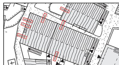
Fig. 2.3-48 - Simbolo delle finestre principali (rappresentate con una linea continua) e secondarie (linea tratteggiata).
