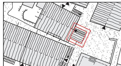
Fig. 2.3-74 - Simbolo delle scale esterne con passaggio sottostante.
