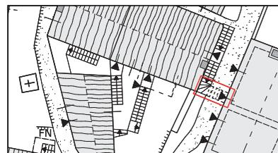
Fig. 2.3-72 - Simbolo delle scale esterne con passaggio sottostante.
