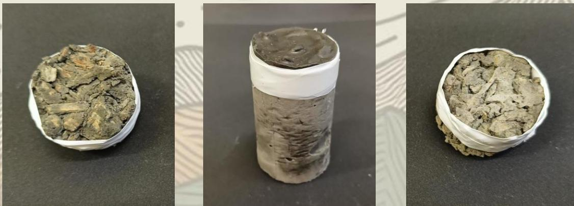
Sono stati realizzati i provini per le **prove di fonoassorbimento in tubo di impedenza**, di dimensioni standard 35 mm di diametro e diverse altezze, in modo di valutare l'efficacia dello spessore sullo spettro di assorbimento acustico.
