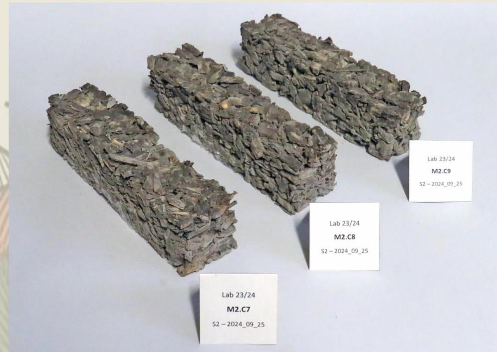
Sono stati realizzati inoltre i provini per le **prove di resistenza a trazione e compressione** di dimensione standard 160x40x40 mm.
