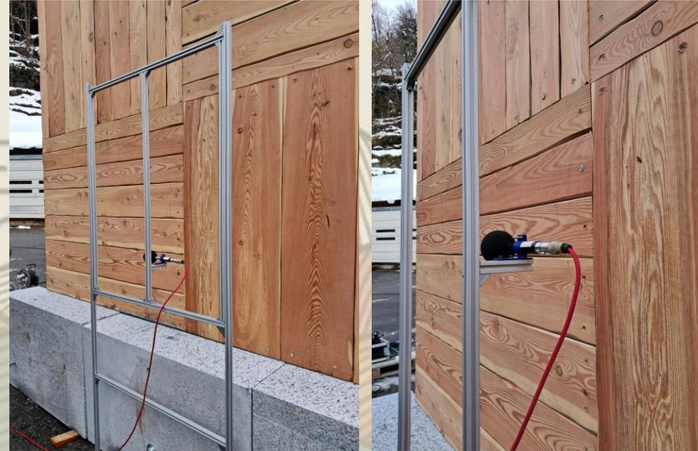
È stato utilizzato un singolo microfono NTI Audio XL2 spostato progressivamente nelle nove posizioni di misura.
