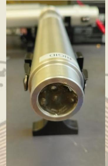
I test preliminari in tubo di Kundt (o di impedenza) hanno permesso una prima indagine sulle caratteristiche di fonoassorbimento delle miscele realizzate. È stata valutata inoltre la performance fonoassorbente del cippato «sciolto».
