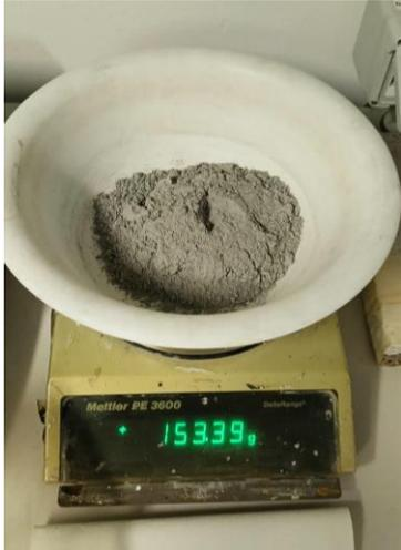
Sono state realizzate 3 diverse miscele, variando le proporzioni di materiale lapideo, soluzione attivante e cippato. I primi provini sono stati realizzati in una scala di laboratorio per valutare le caratteristiche intrinseche del materiale dal punto di vista meccanico e acustico.
