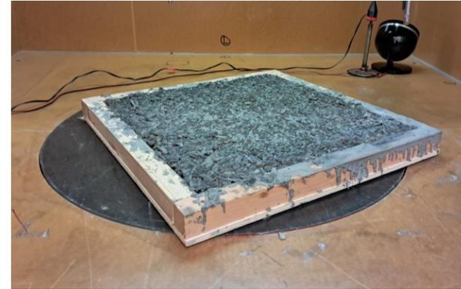
I test effettuati su quattro campioni 50x50x4 cm, realizzati con miscela M2 mostrano una curva di assorbimento simile a quella rilevata in tubo di impedenza, con la stessa variabilità di risultati tra i diversi campioni.
