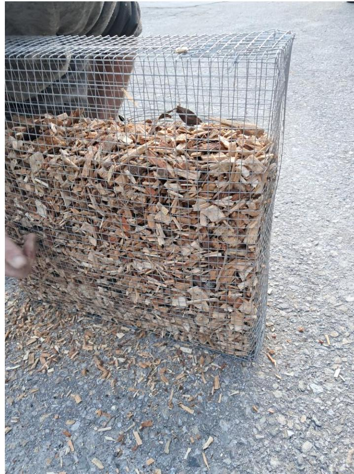
Sono state realizzate delle griglie riempite di cippato da implementare alla barriera come elementi modulari fonoassorbenti, facilmente realizzabili, aggregabili e sostituibili.
