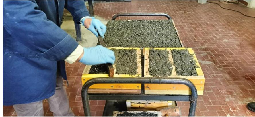
Realizzazione provini 250x90x60 mm per prove di resistenza al fuoco.
